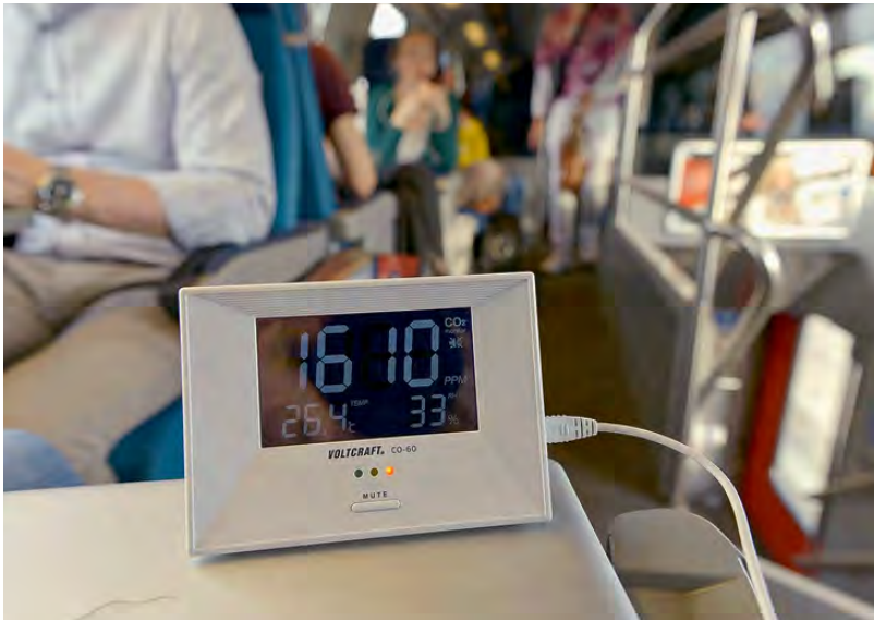
Messgerät: CO 2 -Gehalt von 1610 ppm – viel zu hoch
